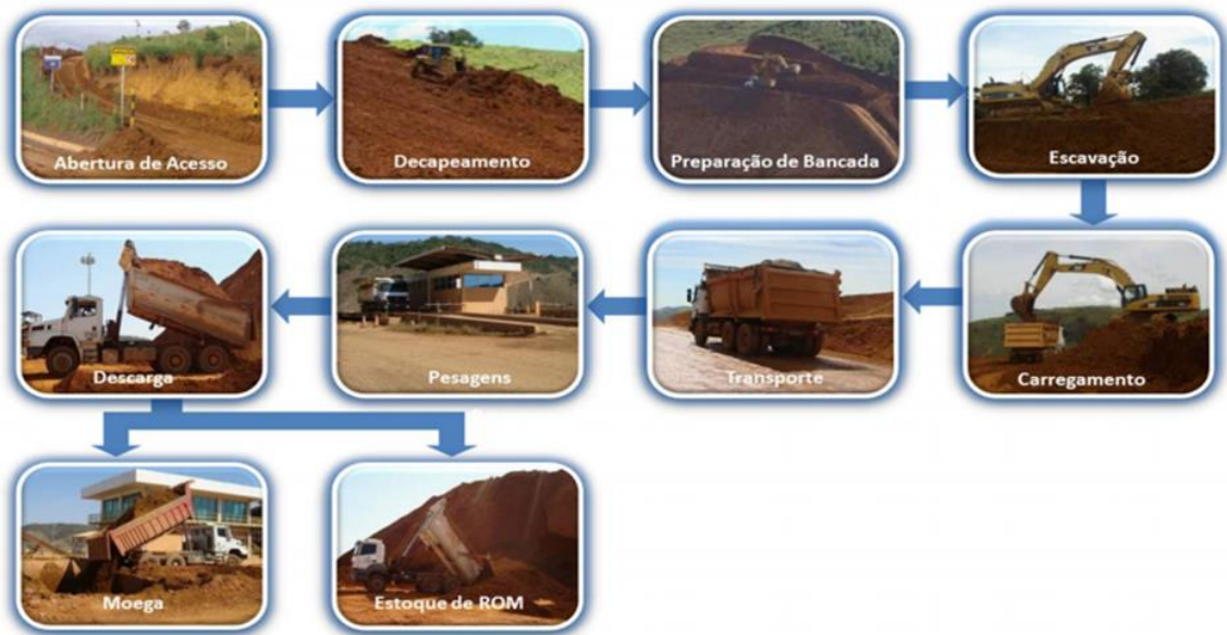
Figura 3: Etapas do processo de exploração da bauxita.
