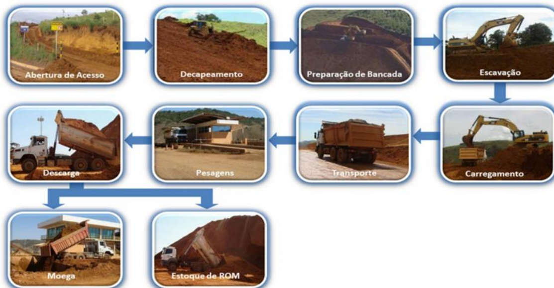
Figura 3: Etapas do processo de exploração da bauxita.
