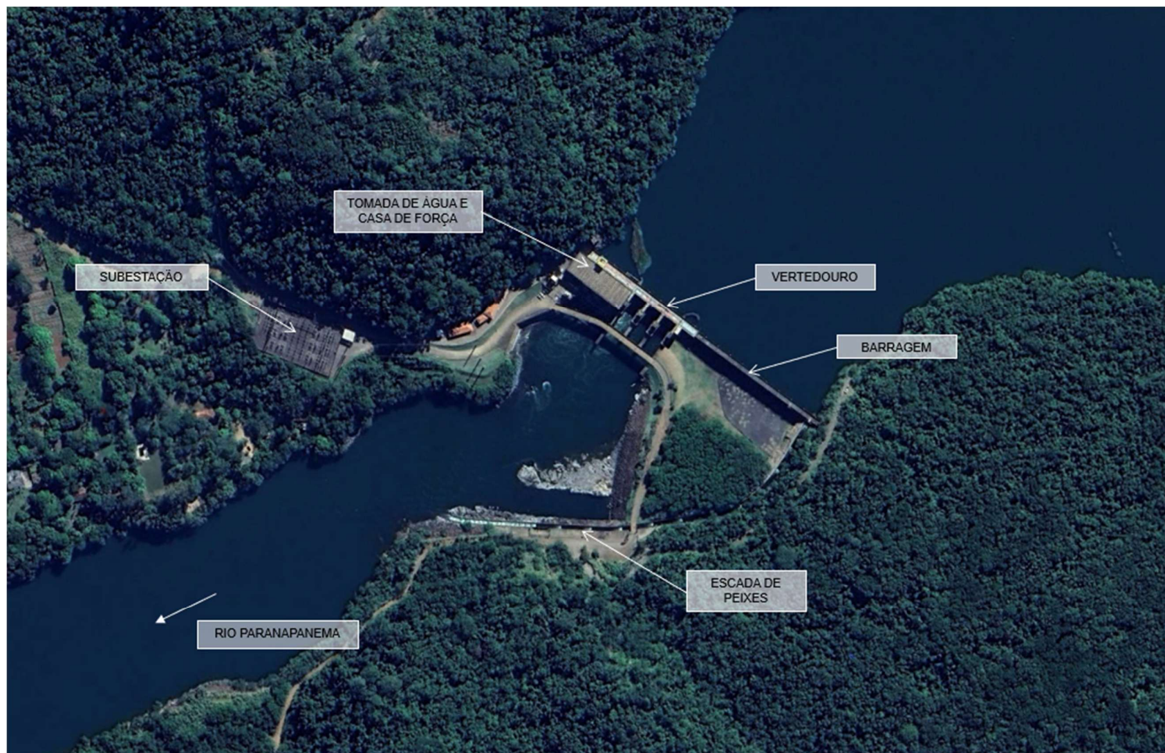
Figura 1. UHE Ourinhos – Arranjo Geral - Planta.
